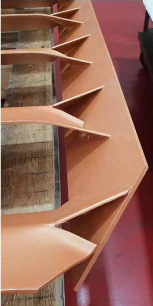
Métal déployé coupé en biais pour assemblage sur un cadre à bord incliné
