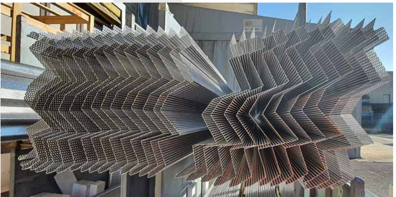
Pliage de formes complexes par commande numérique
