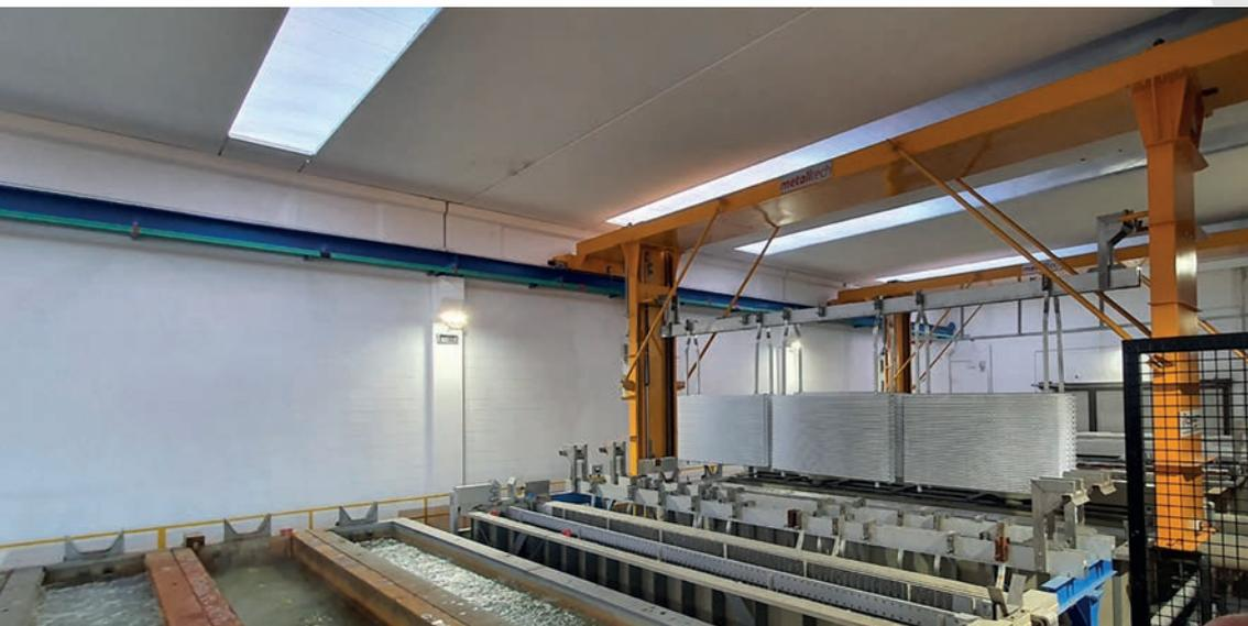
L'anodisation est le traitement de surface spécifique de l'aluminium qui consiste à créer par électrolyse une couche uniforme très résistante d'oxyde d'aluminium. Cette couche peut être incolore ou colorée
